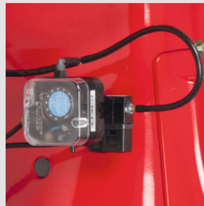
Der Feuerungsmanager testet den Luftdruckwächter mit zusätzlichem Magnetventil auch bei Motornach- bzw. -dauerlauf auf seine Funktion und sorgt somit für höchste Sicherheit
