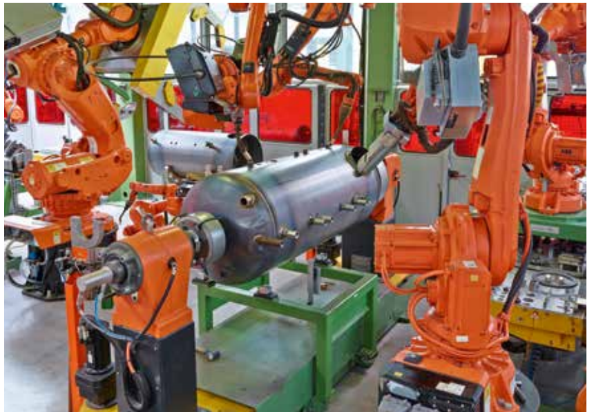
Fabrication de ballons entièrement automatisée
