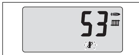
In questo lasso di tempo, ruotando la manopola è possibile entrare nel livello tecnico e riavviare il conto alla rovescia di 2 minuti. Questo permette di eseguire interrogazioni nel livello Info sui valori dell'impianto in relazione alla potenza corrispondente.
