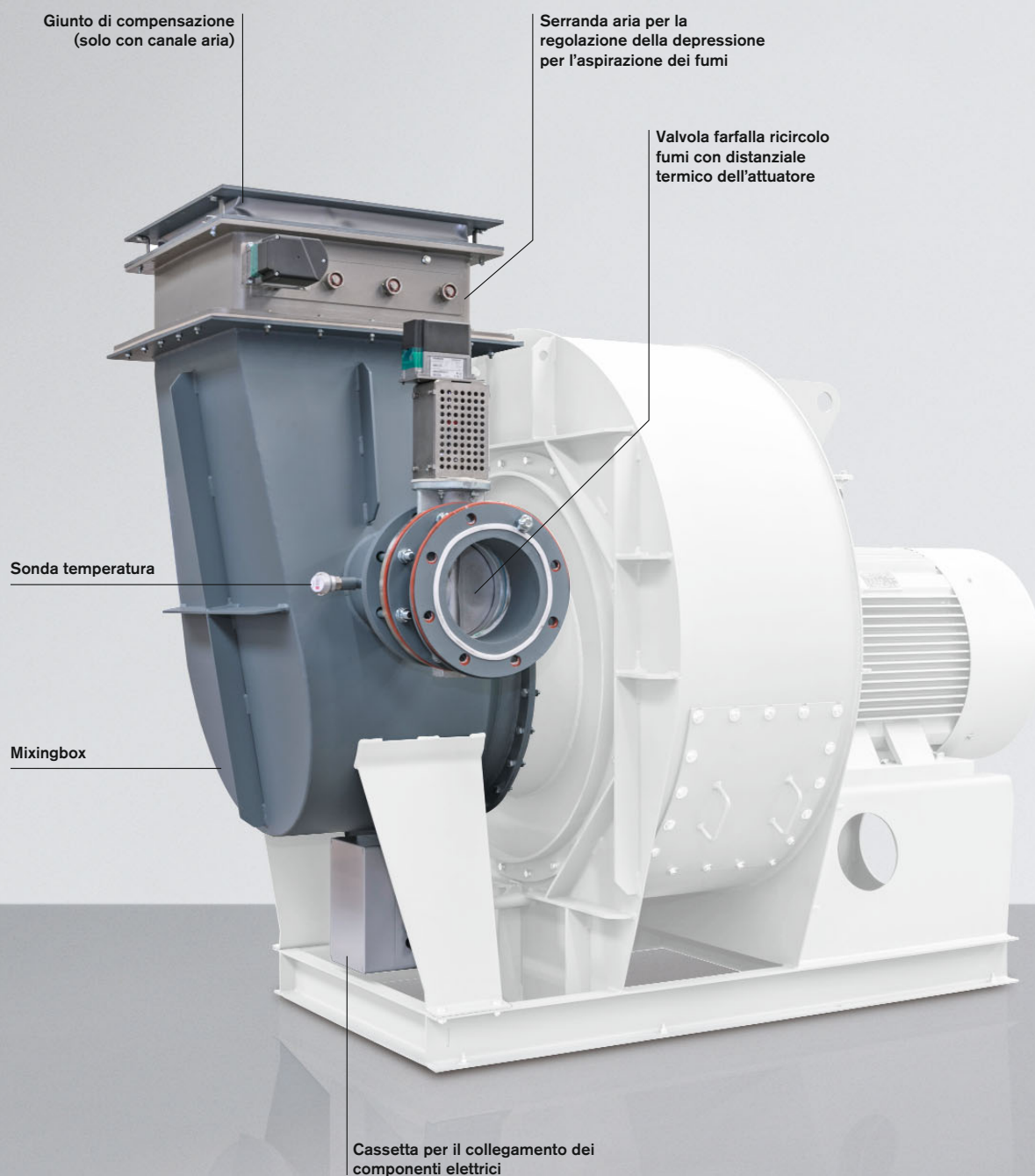
Mixingbox per ricircolo fumi al ventilatore aria comburente
