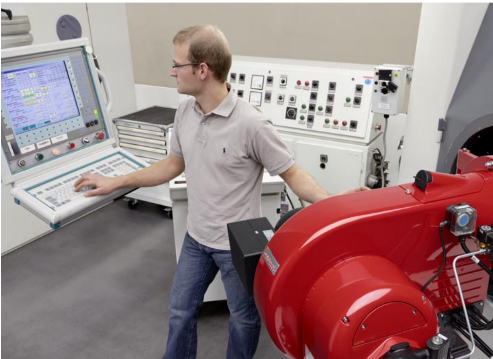
Am speziellen Prüfstand werden alle Brenner in Schiffsausführung vor Auslieferung umfassend geprüft
